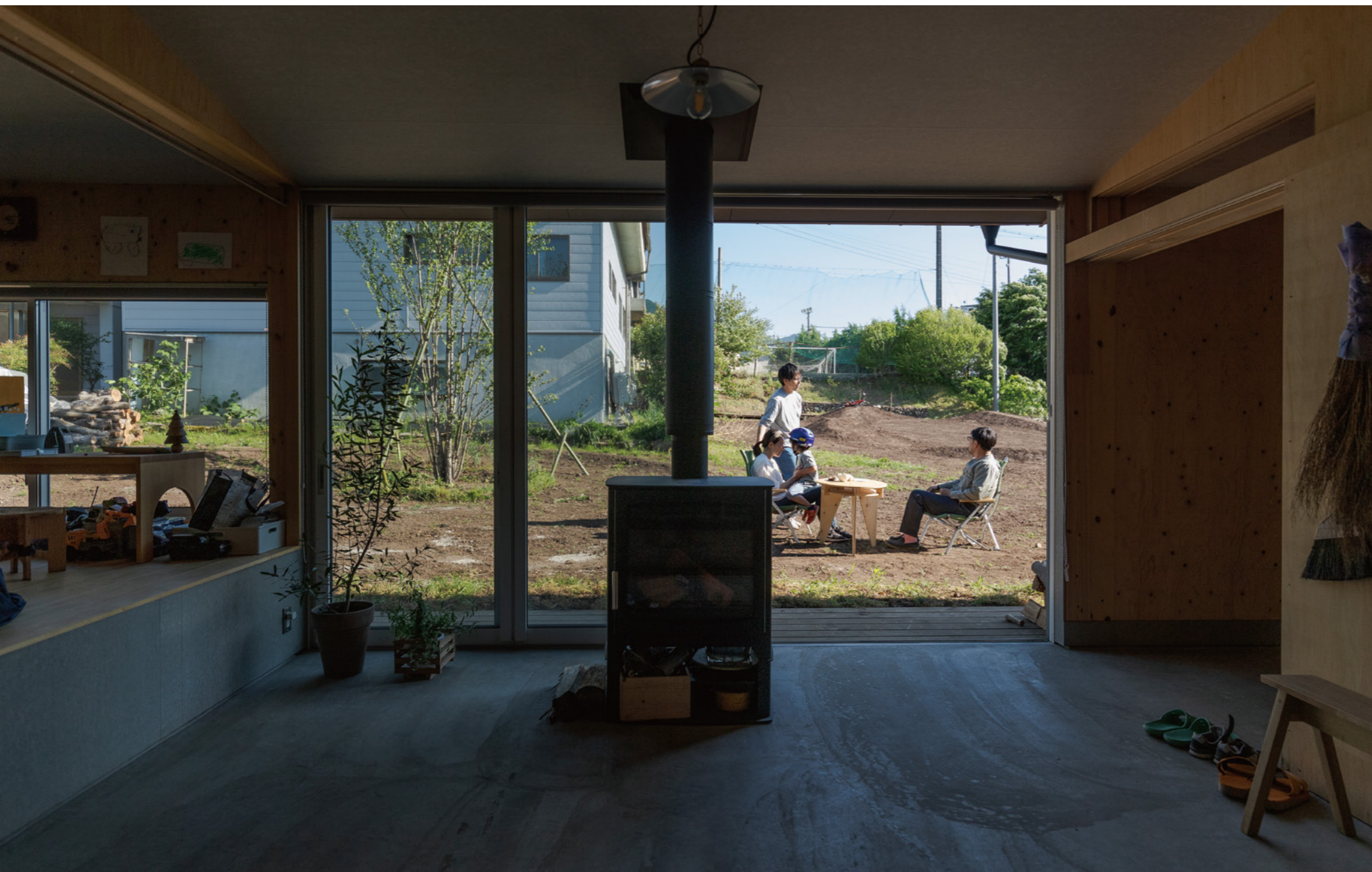
コンセプトである「庭はリビング、リビングは庭」を体現する仕掛けとして土間→デッキ→庭のレベルをフラットにしている。
